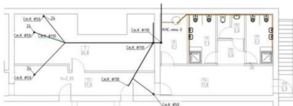
АксонOMETрична схема мереж каналізації сходища.
