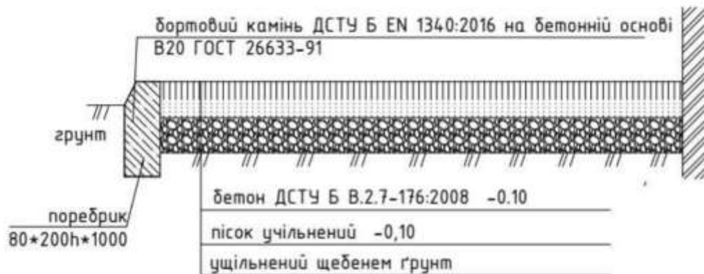
Рисунок 3 – Конструкція покриття
