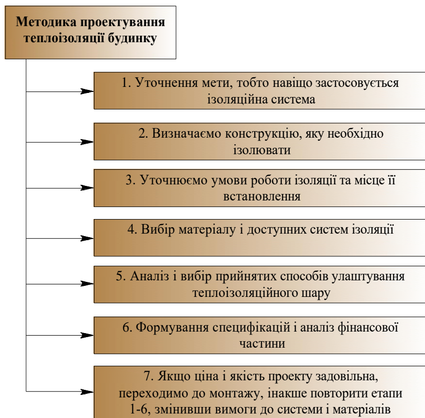
Рис.1.1. Методика проектування термоізоляції будинку
