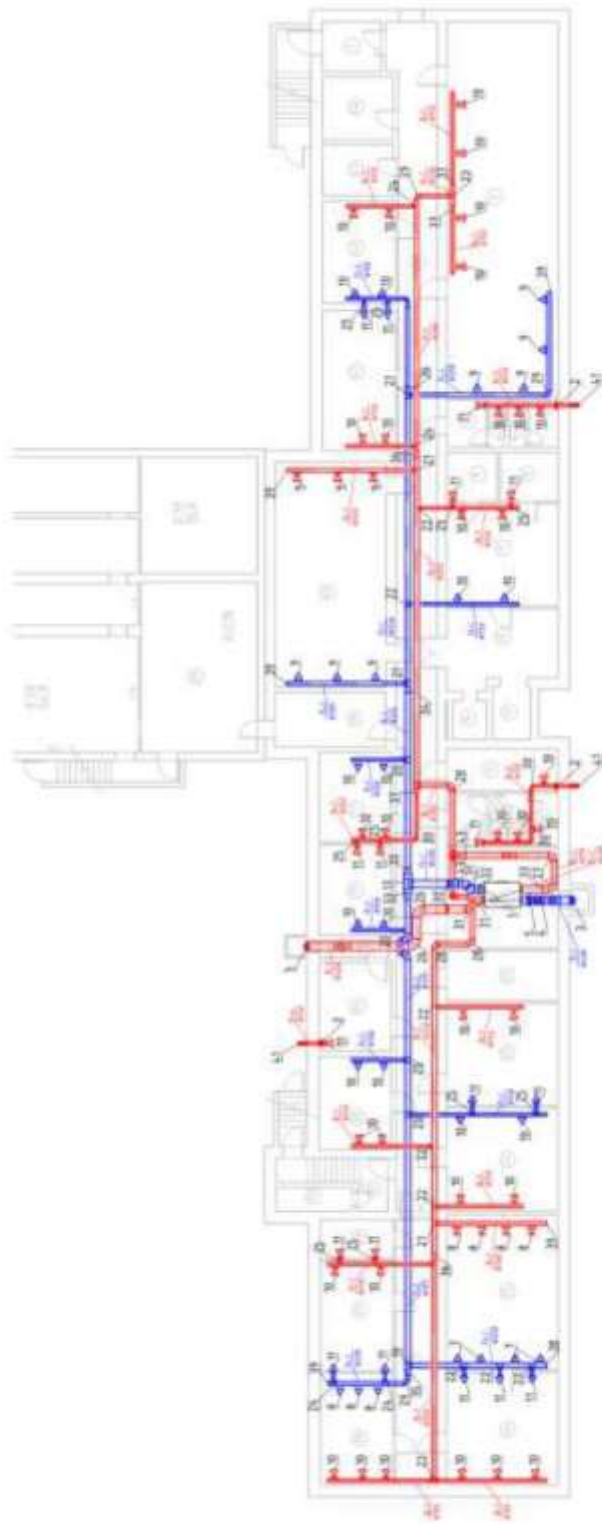
Рис.17. План системи вентиляції укриття
