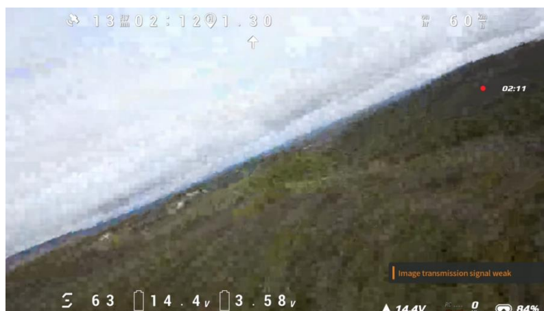
Рисунок 2.7– Зниження якості сигналу в DJI
