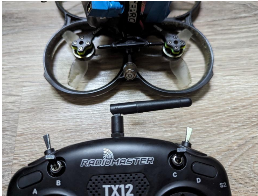
Рисунок 4.14 – Розміщення антен лінійно-горизонтальної поляризації
