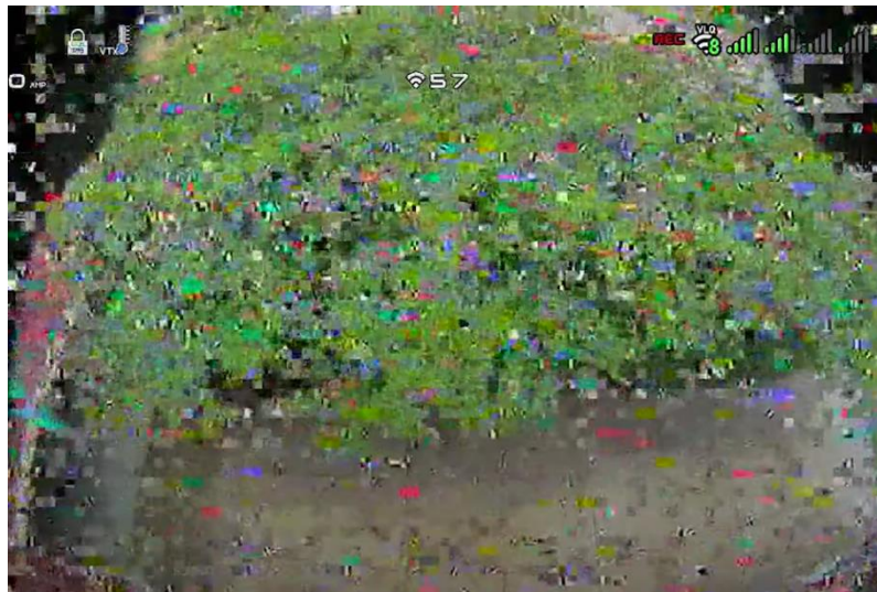
Рисунок 2.5– Зниження якості сигналу в HDZero
