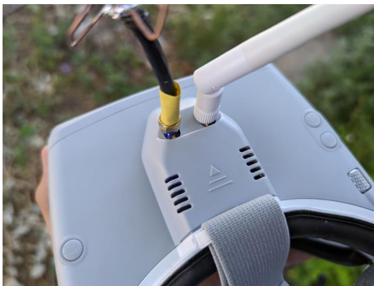
Рисунок 4.13 – Розміщення антени diversity-приймача
