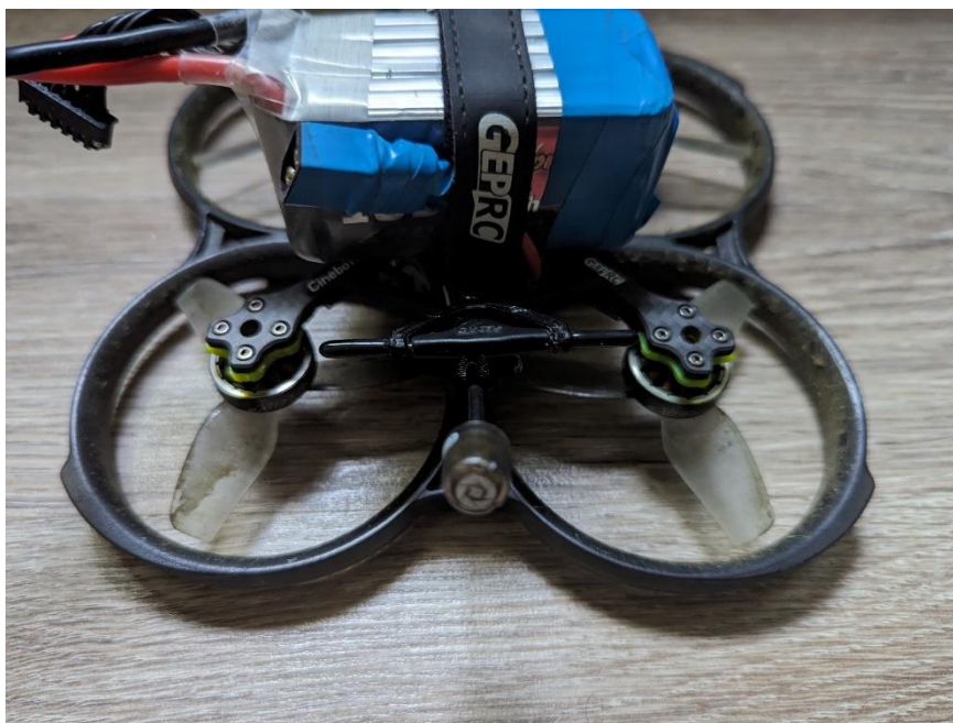
Рисунок 4.12 – Розміщення антени передавача дрону
