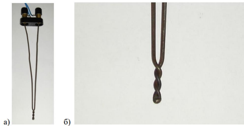
Рисунок 1.4 – Проста конструкція термопари (а); вид контакту термопари (б)
