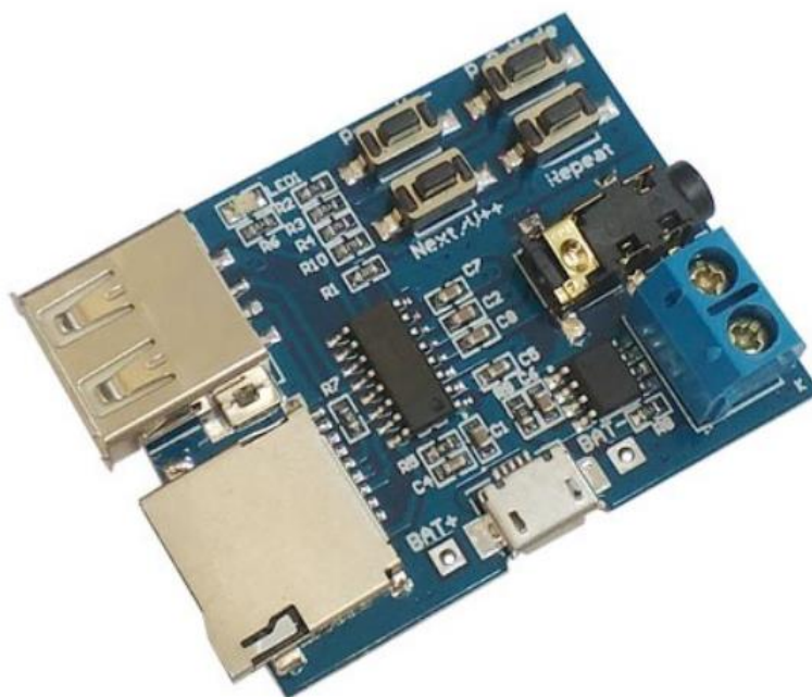
Рисунок 3.8 - Голосовий (звуковий) модуль USB/SD MP3 декодер GPD2856
