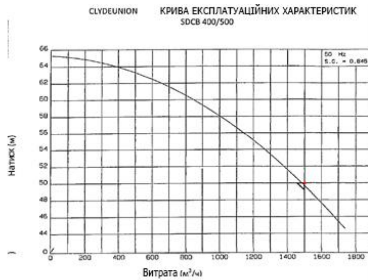
Рисунок 2.1 Крива експлуатаційних характеристик насосу типу UNIGLIDE SDCB 400/50
