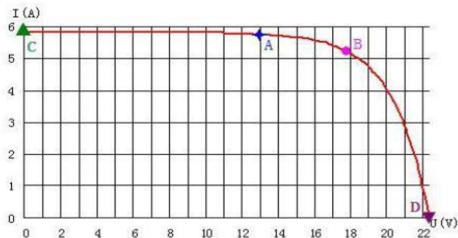
Рисунок 2.2 – Вольт-амперна характеристика контролера
