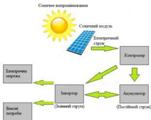
Рисунок 1.1 - Схема сонячної електростанції
