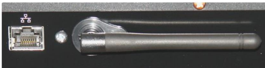
Рис. 2.4. Безпроводові антени дозволять збільшити радіус дії безпроводових мереж
