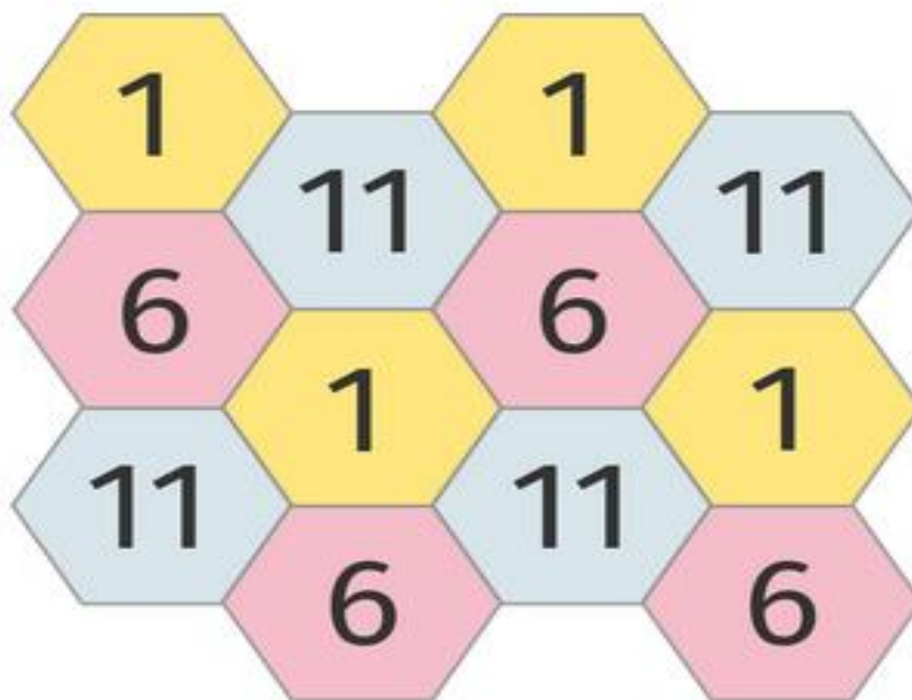
Рис. 2.7. Розподіл на площині каналів, які не перекриваються
