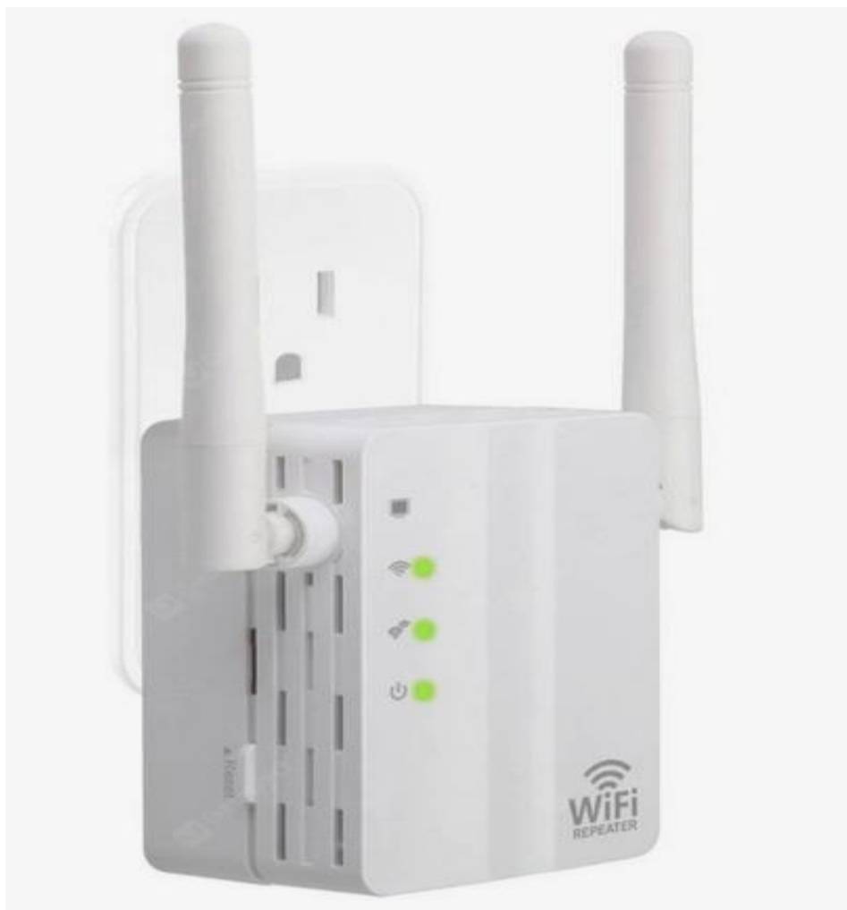
Рис. 2.5. Подібно до стандартної антени, цей пристрій дозволить розширити радіус дії безпроводової мережі.
