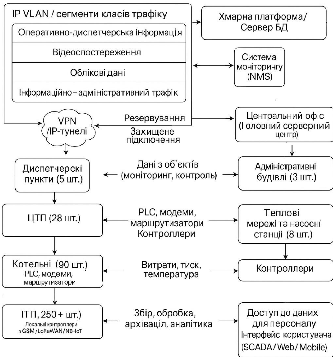
Рисунок 2.4 – Схематичне зображення взаємодії елементів цифрової мережі
