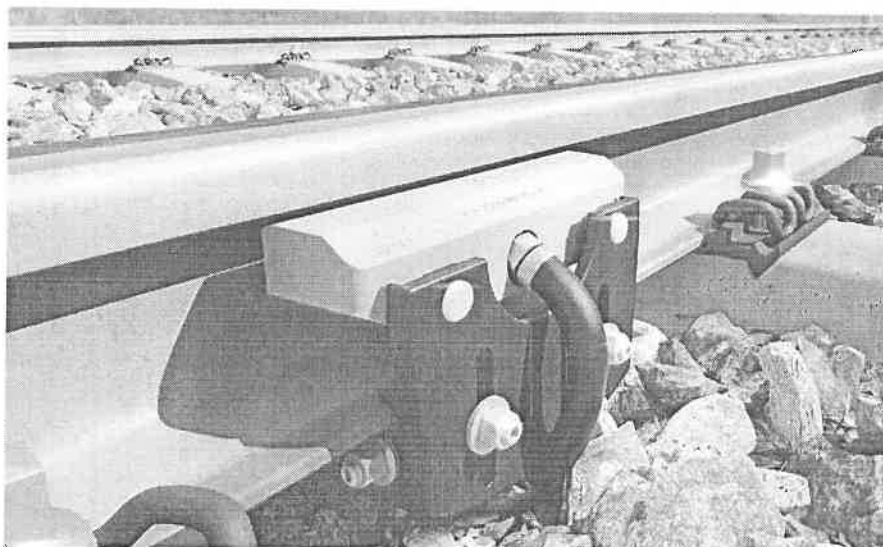
Рисунок 1.2 – Датчик подвійної системи RSR180 [8]
