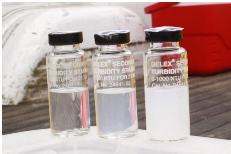
Рисунок 3.19 – Зображення для візуальної апроксимації значення NTU
