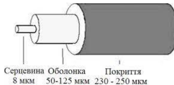
Рисунок 1.6 – Структура оптоволоконного кабелю
