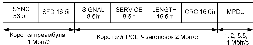
Рисунок 1.8 Короткий заголовок кадрів мережі 802.11.b
