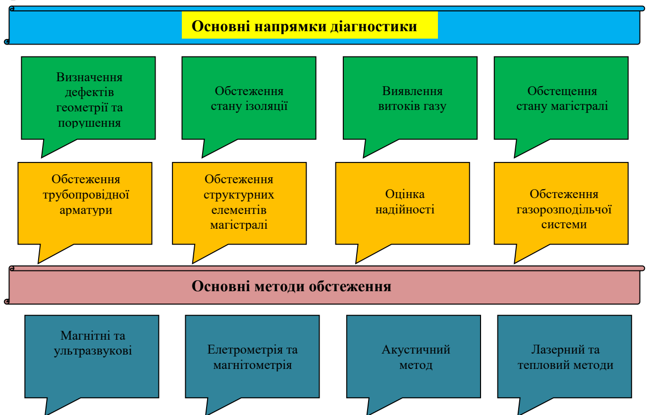
Рисунок 1.1 - Основні методи та засоби моніторингу газопроводів
