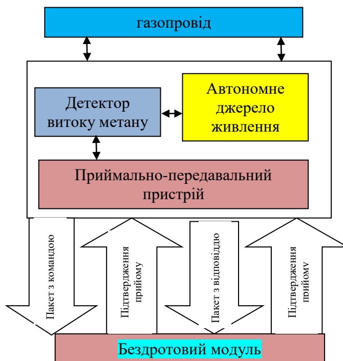
Рисунок 3.2 - Блок-схема БМ з передачею даних
