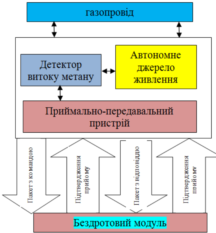
Блок-схема БМ з передачею даних
