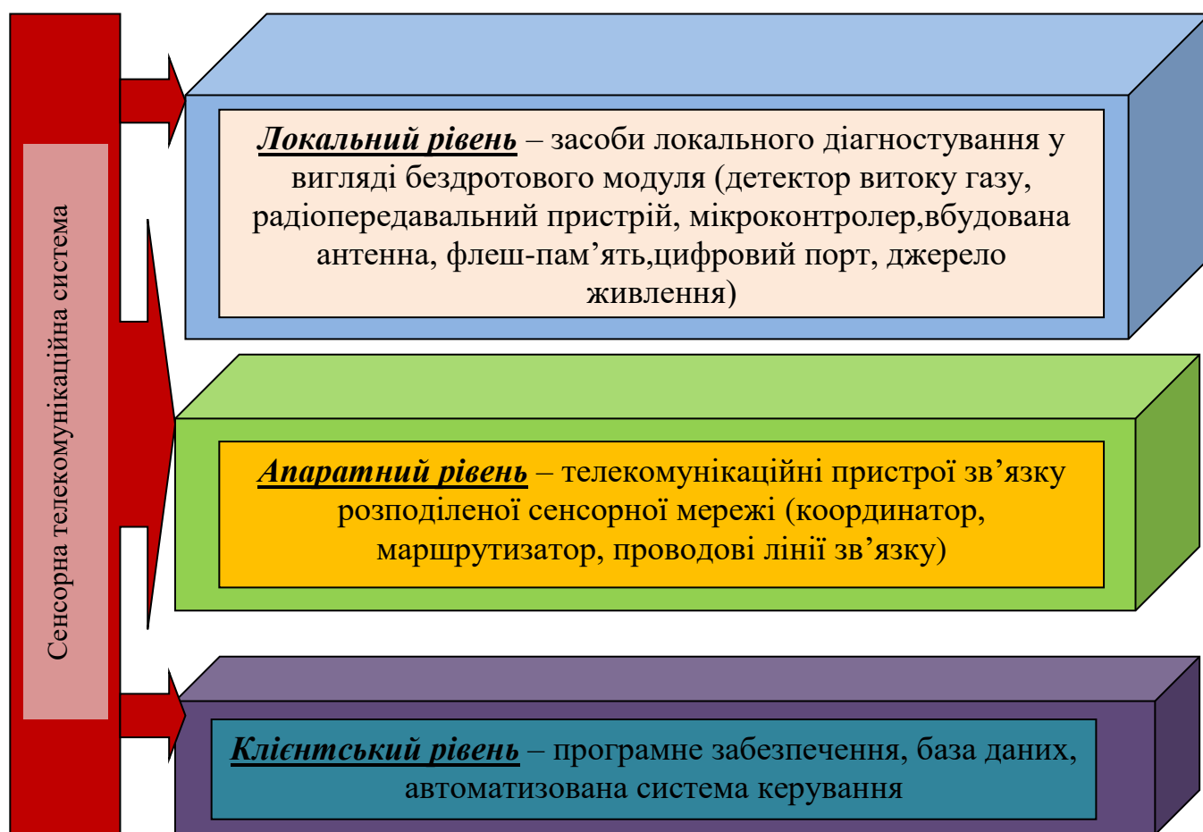
Рисунок 2.2 - Основні рівні керування сенсорної телекомунікаційною системою контролю витоку газу
