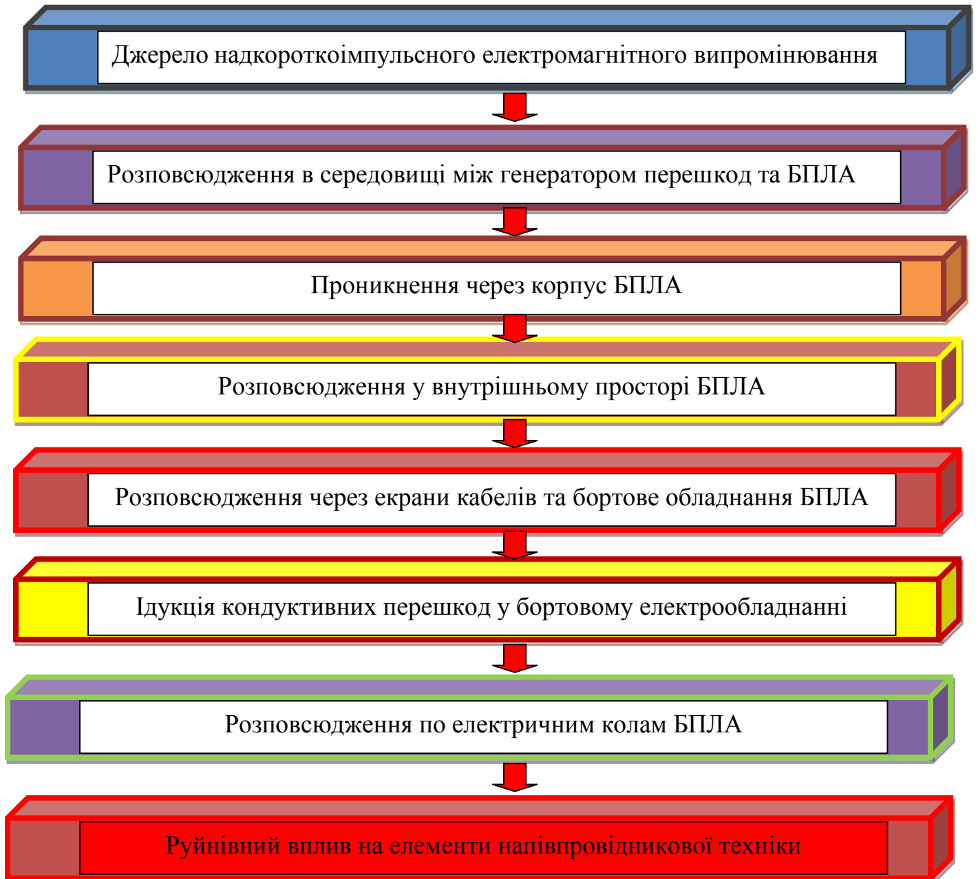
Рисунок 2.3– Процес розповсюдження електромагнітних перешкод у внутрішньому просторі БПЛА
