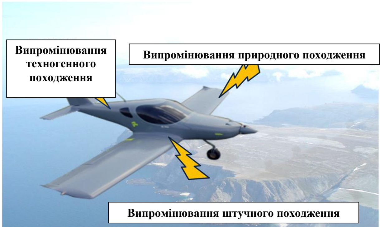
Рисунок 1.1 – Склад електромагнітних впливів, яким піддається БПЛА у процесі виконання завдань
