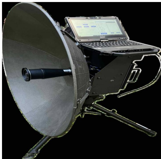
Рис 3.1. Станція тропосферного зв'язку «СОМЕТ»
