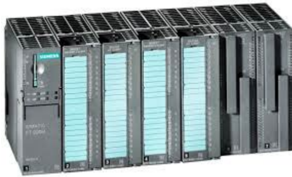
Рисунок 3.2 – Модуль введення/виведення SIMATIC ET 200M лінії виробництва шоколадної глазури
