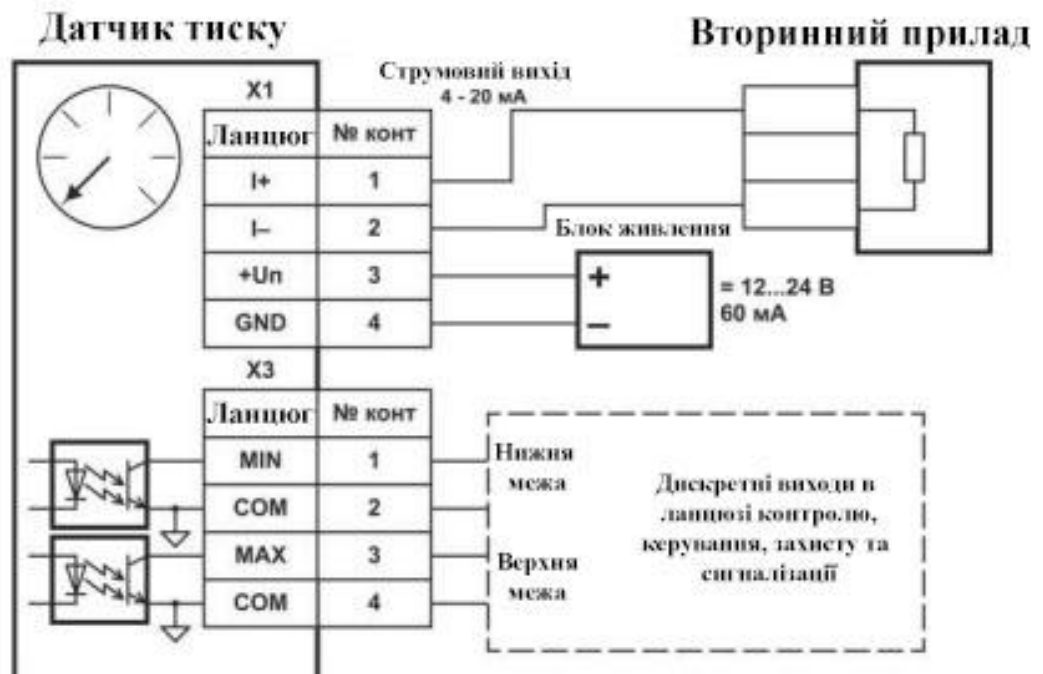
Рисунок 2.4 – Схема підключення датчика тиску АДМ-100.1
