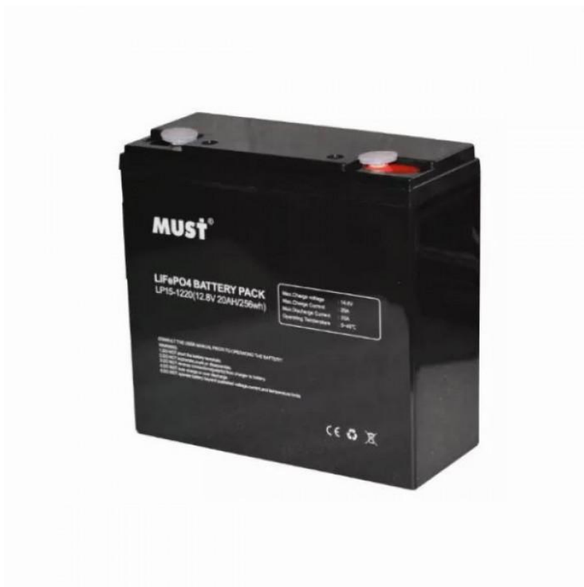
Рисунок 3.5 – Зовнішній вигляд акумуляторної батареї Must LP15-1220.
