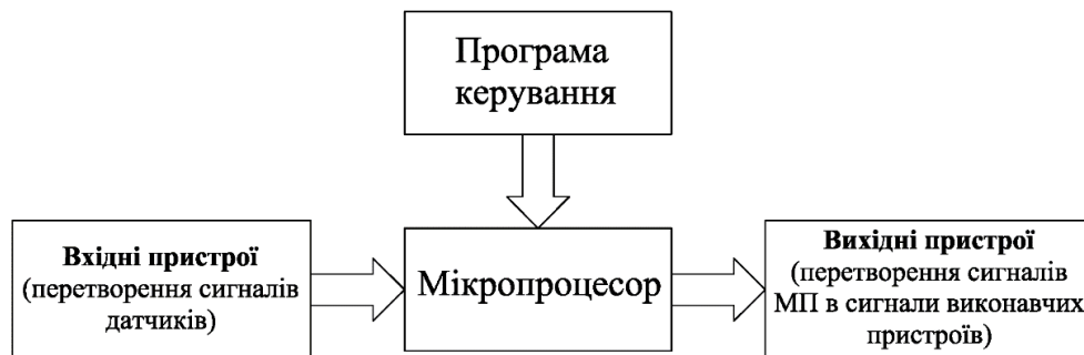
Рисунок 2.2 – Схема системи керування параметрами сушильної камери з урахуванням мікропроцесора
