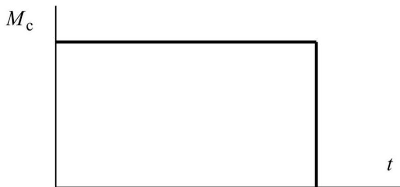
Рисунок 2.3 – Навантажувальна діаграма режиму S1
