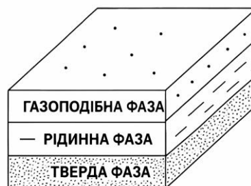
Рис. 2.6 - Трьохкомпонентна діелектрична модель ґрунту.
