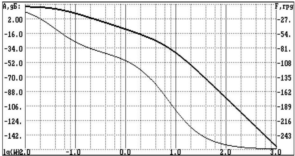
Рис. 4.3 – Логарифмічна амплітудно-частотна характеристика (ЛАЧХ) та логарифмічна фазочастотна характеристика (ЛФЧХ) вихідної системи автоматичного контролю (САК).
