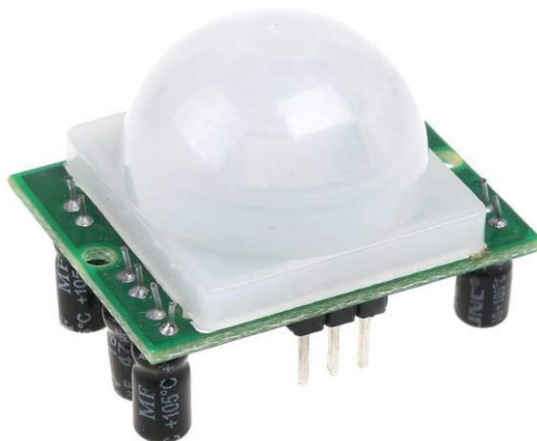
Рис. 1.3 - Датчик руху PIR HC-SR501 (Passive Infrared Sensor)
