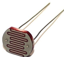
Рис. 1.2 - Датчик освітленості LDR (Light Dependent Resistor)
