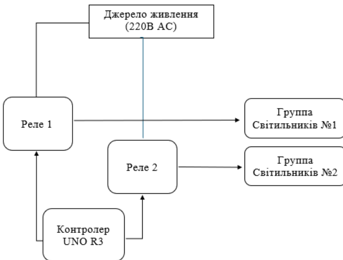
Рис 2.3 - Схема системи комутації двох рівнів освітлення
