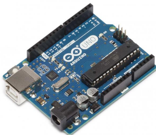
Рис. 1.1 - Плата розробника Arduino UNO R3
