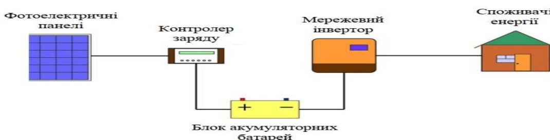
Рисунок 1.8 Автономна схема підключення (Off-grid)
