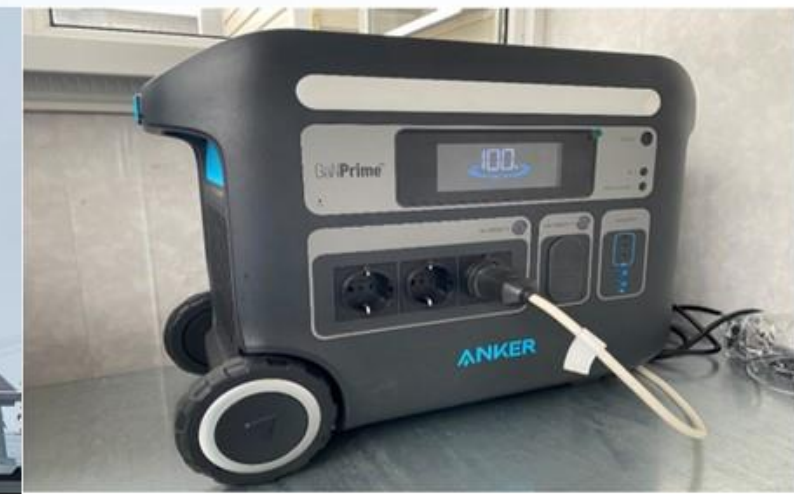
Рисунок 1.13 – Портативна електростанція Anker
