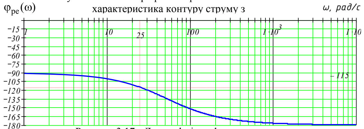
Рисунок 3.17 - Логарифмічна фазочастотна характеристика контуру ЕРС
