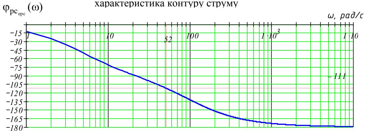
Рисунок 3.16 - Логарифмічна фазочастотна характеристика контуру струму з
