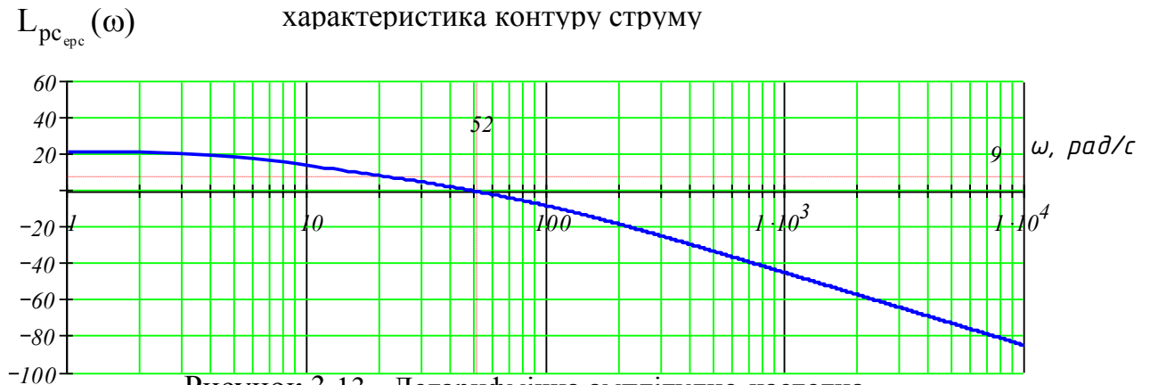
Рисунок 3.13 - Логарифмічна амплітудно-частотна характеристика контуру струму з врахуванням 33
