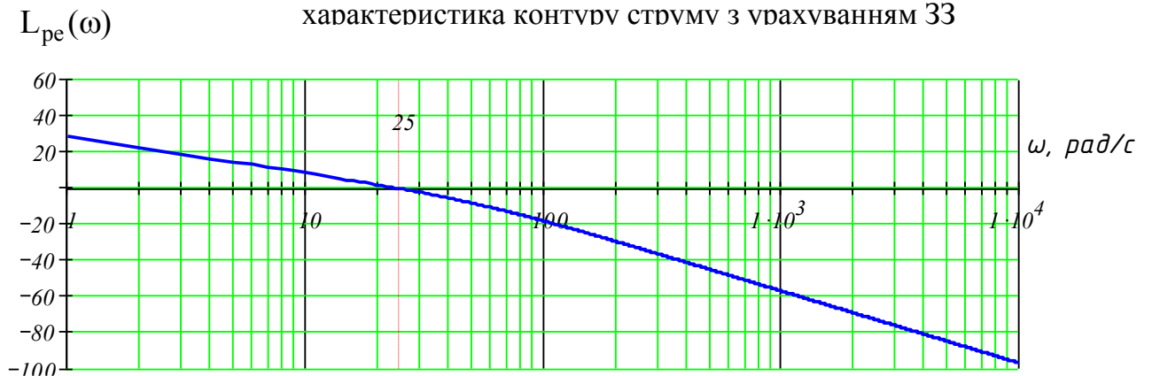
Рисунок 3.14 - Логарифмічна амплітудно-частотна характеристика контуру ЕРС
