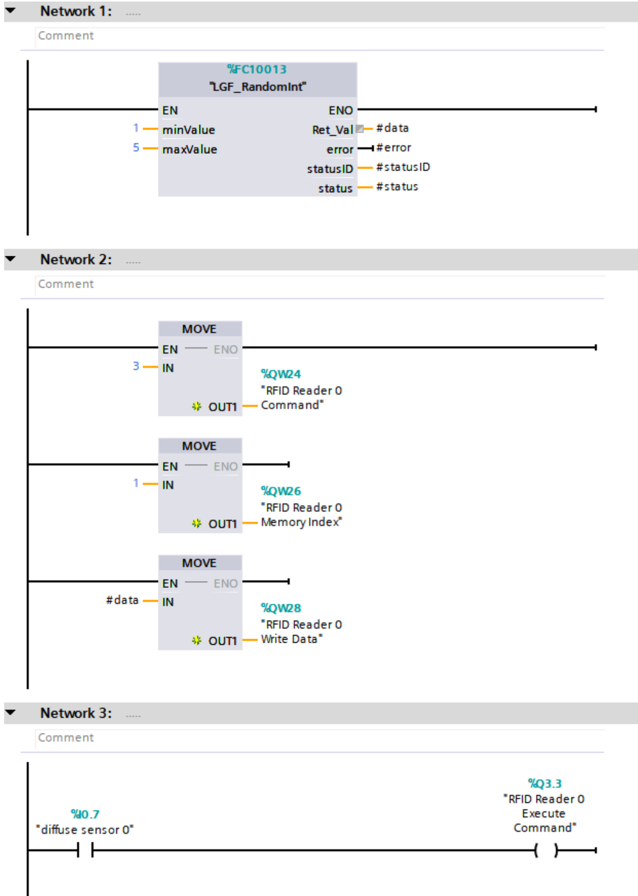
Рисунок 5.20 – Алгоритм запису даних на RFID-мітки вантажу
