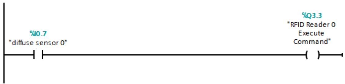
Рисунок 5.7 – Приклад взаємодії дифузійного датчика та RFID-считувача
