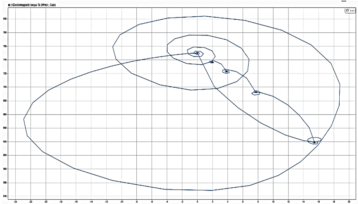
Рисунок 6.7 Динамічна механічна характеристика асинхронного двигуна при пуску з різним активним моментом навантаження При пуску максимальний момент досягає значення 800 Н·м.
