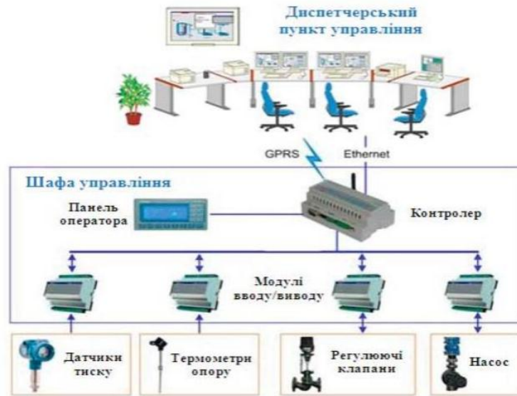
Рисунок 3.29 – Структура автоматизованої системи керування мережевим насосом
