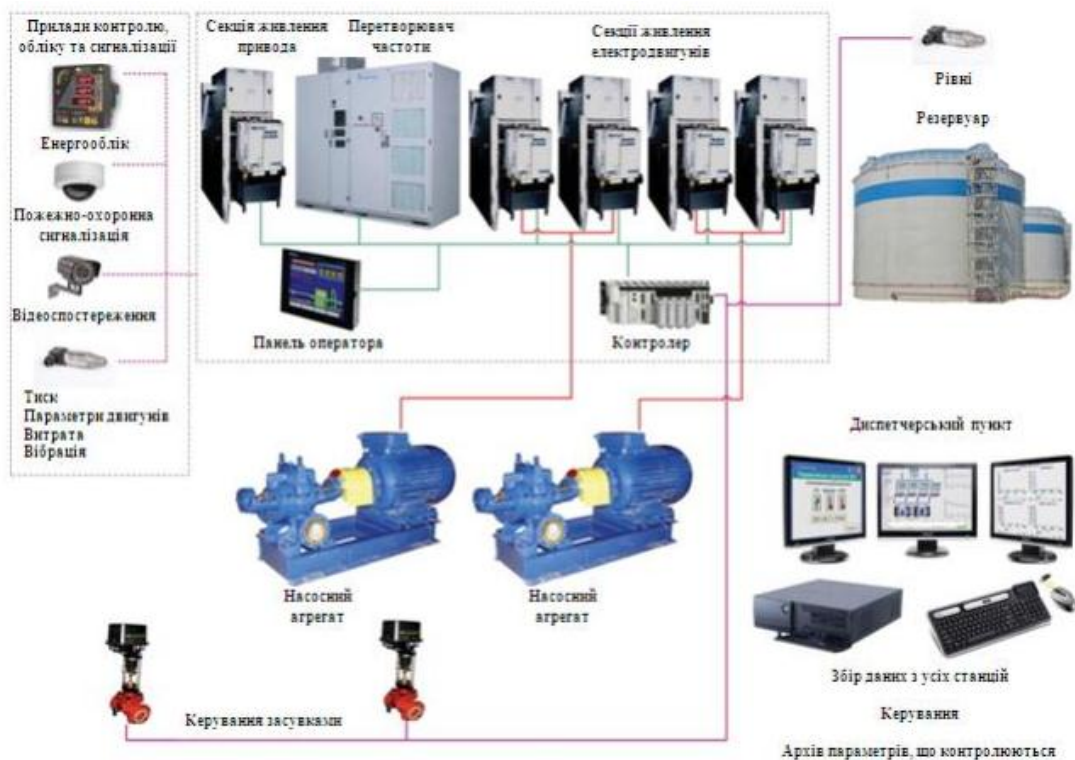
Рисунок 3.30 – Схема автоматизації насосних агрегатів з перетворювачем частоти
