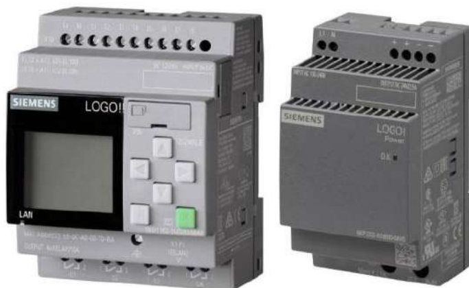
Рисунок 2.4 - Образ контролера Siemens LOGO!
