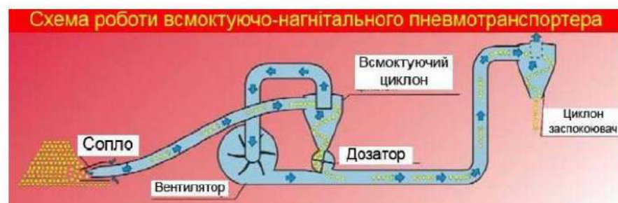
Рисунок 2.2 - Принцип роботи всмоктуючо-нагнітального пневмотранспортера
