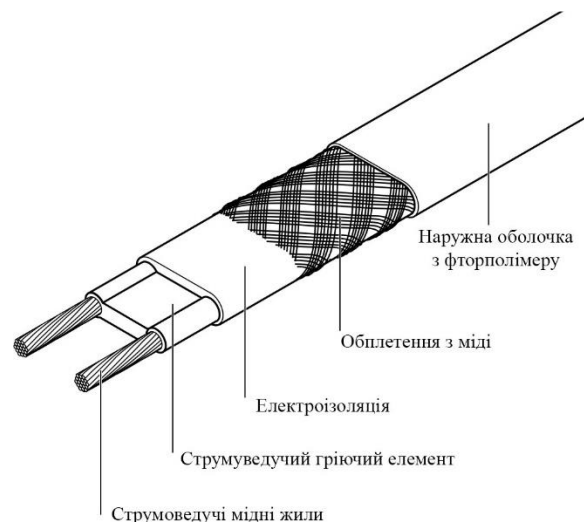
Рисунок 4.16 – Конструкція гріючого кабелю
