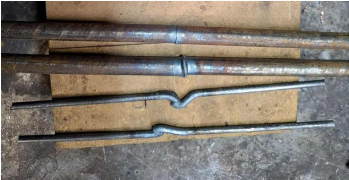
Рисунок 4.1 – Незадовільні результати зварювання перед оптимізацією машини
