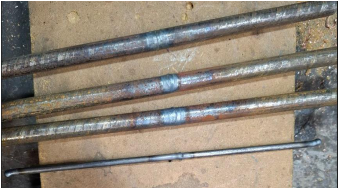
Рисунок 4.2 – Задовільні результати зварювання після оптимізації машини
