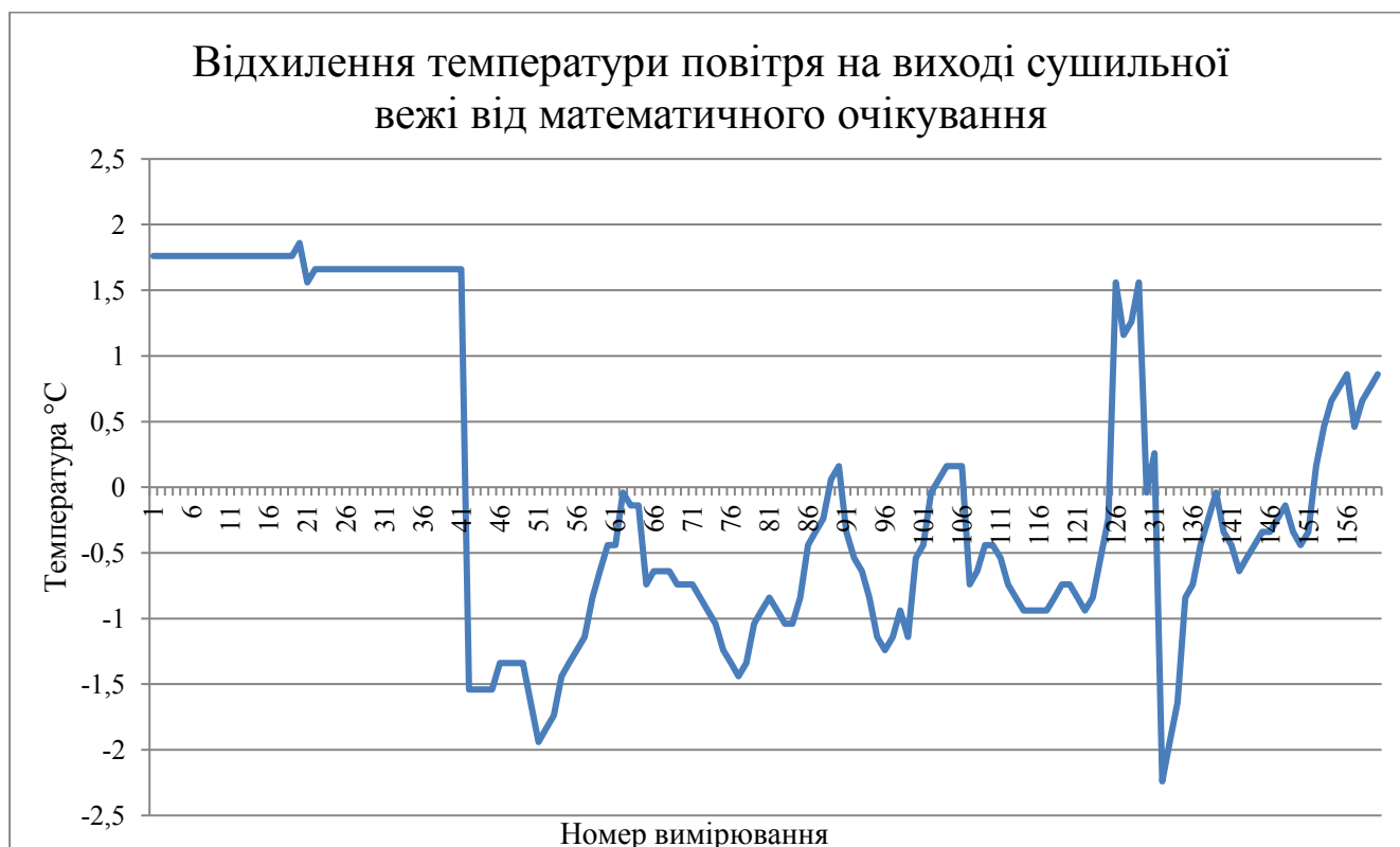
Рисунок 1.4.6 - Графік відхилення температури повітря на виході сушильної вежі від математичного очікування
