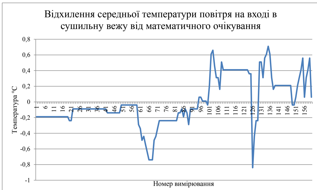
Рисунок 1.4.4 - Графік відхилень середньої температури повітря на вході в сушильну вежу від математичного очікування
