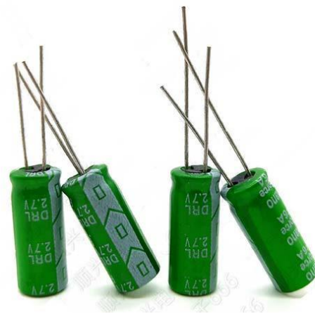
Рисунок 3.1.3 – Зовнішній вигляд суперконденсаторів
