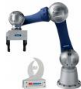
Шестиступеневий робот LWA 4.6 від компанії SHUNK
