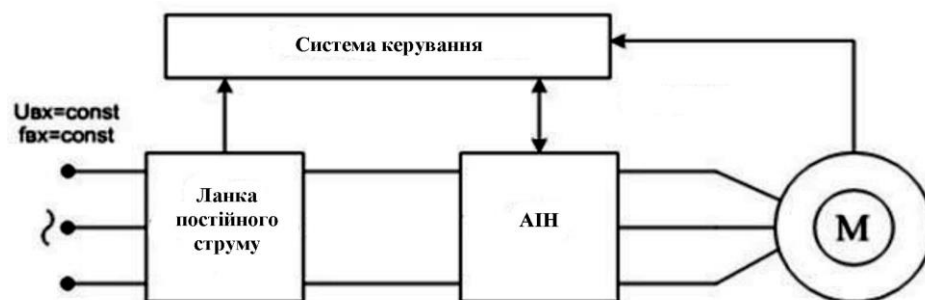
Рисунок 2.8 – Спрощена функціональна схема системи електроприводу
