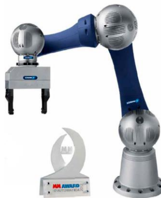
Рисунок 1.13 – Шестиступеневий робот LWA 4.6 SHUNK
