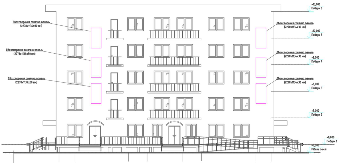
Рис 3.4 - Встановлені панелі на фасаді.
