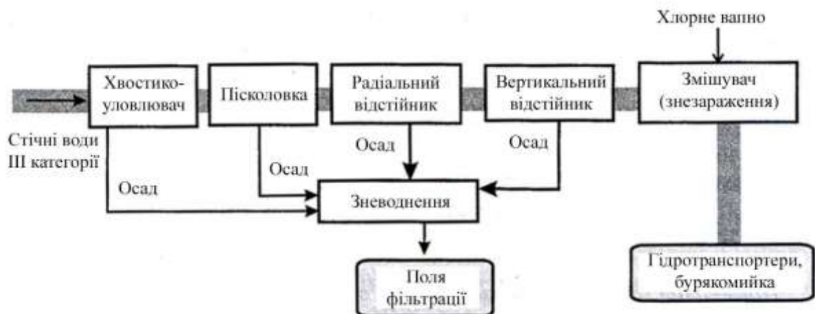
Рисунок 1.2 – Принципова схема очищення транспортно-мийної стічної води
