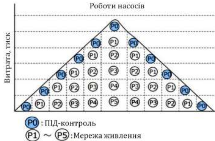
Рисунок 2.14 – Ілюстрація каскадного вмикання та вимикання насосів
