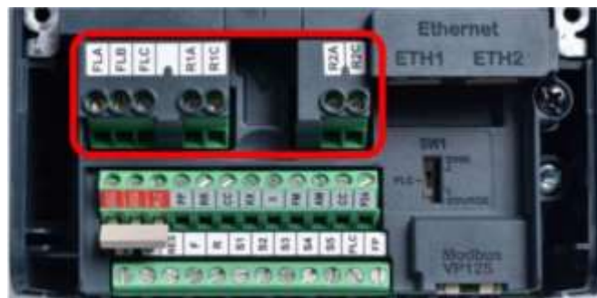
Рисунок 2.11 – Клеми для керування роботою 4-х насосів за допомогою частотника
