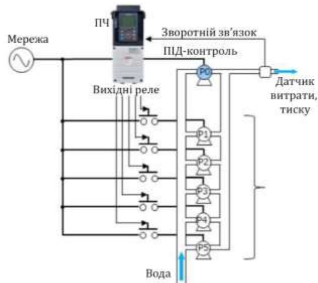
Рисунок 2.13 – Каскадне вмикання та вимикання насосів за допомогою перетворювача частоти
