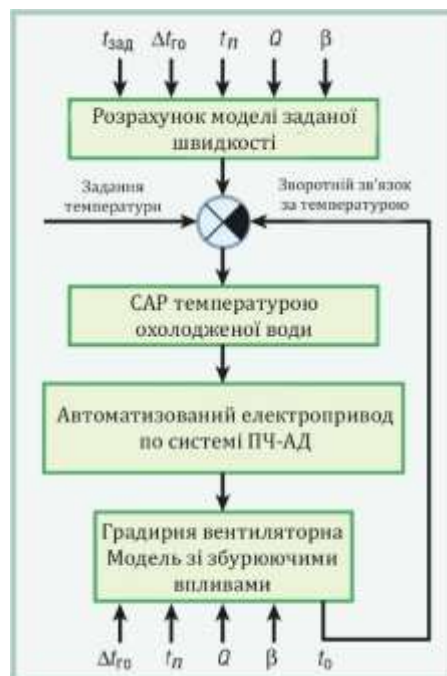
Рисунок 4.6 – Модель перетворення сигналів у замкнутій системі керування швидкістю 68 електроприводи вентиляторної градирні
