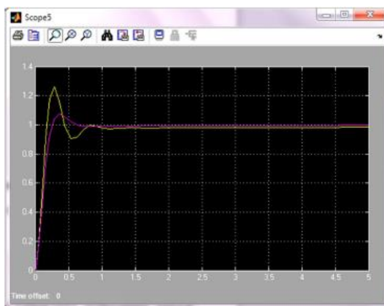
Рисунок 4.13 – Якісні характеристики роботи нечіткої нейронної САК холодопродуктивністю компресора в порівнянні з ПІД регулятором
