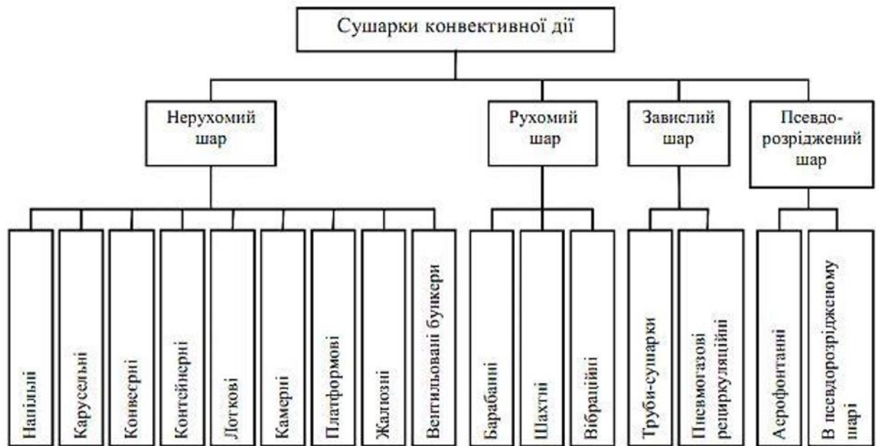
Рисунок 1.10 – Класифікація основних типів конвективних сушильних установок для сушіння зерна
