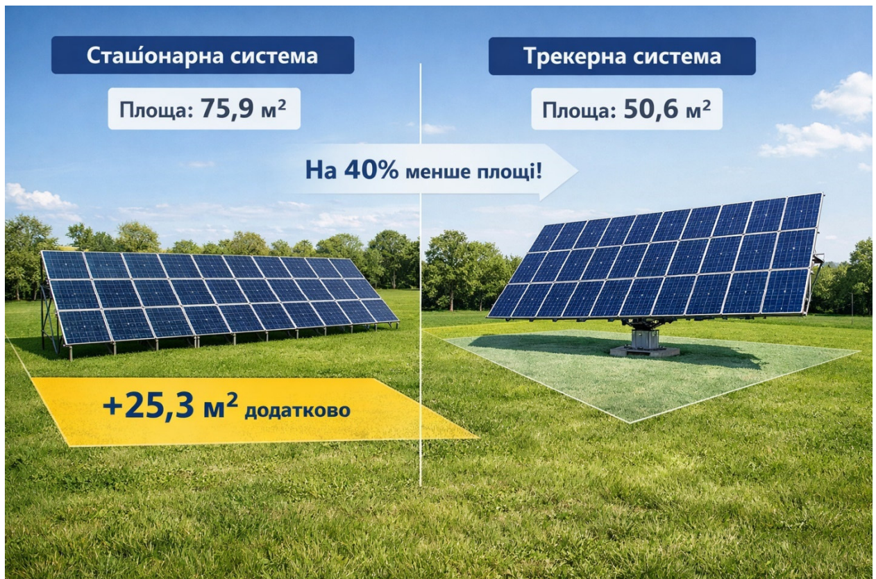
Рисунок 3.3 - Порівняння просторових вимог стаціонарної та трекерної ФЕС
