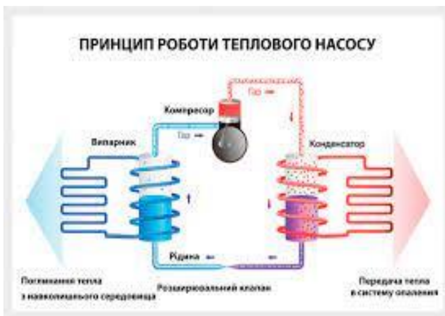
Рисунок 1.1 — Принцип роботи теплового насосу
