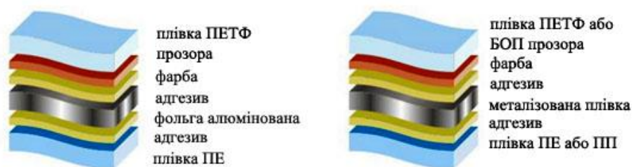
Рисунок 1.2 – Структура паперу типу
