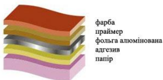
Рисунок 1.1 – Структура ламінованого паперу
