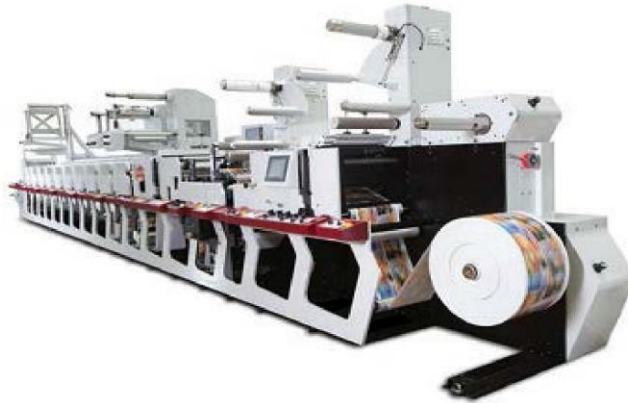
Рисунок 1.8 – Чотирифарбова багатоциліндрова друкарська машина з рулону на рулон для двофарбового друкування з лиця та з обороту, з пристроєм для згинання сторінок
