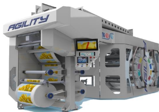
Рисунок 1.9 – Сучасна восьмифарбова машина з центральним циліндром
