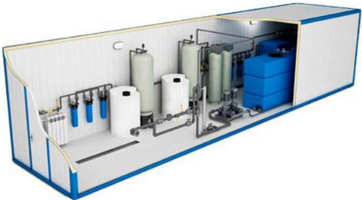
Рисунок 1.13 – Насосна станція блочно-модульного типу
