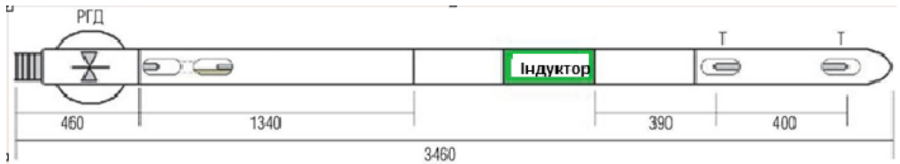
Рисунок 3.1 – Схема приладу активної термометрії з індукційним нагрівачем
