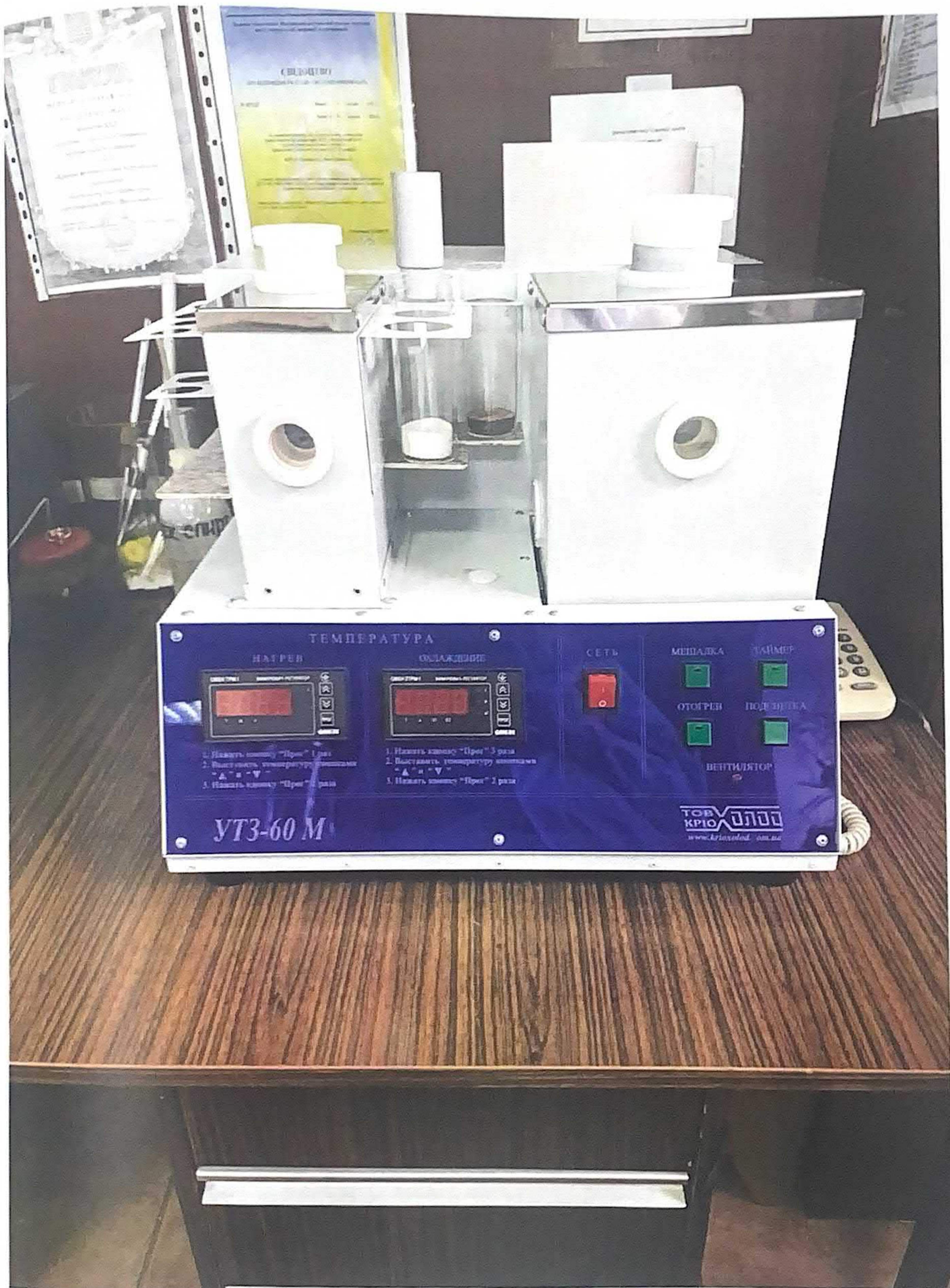
Рисунок 2.1 – Установка для визначення температури застигання та текучості по ГОСТ 20287-91
