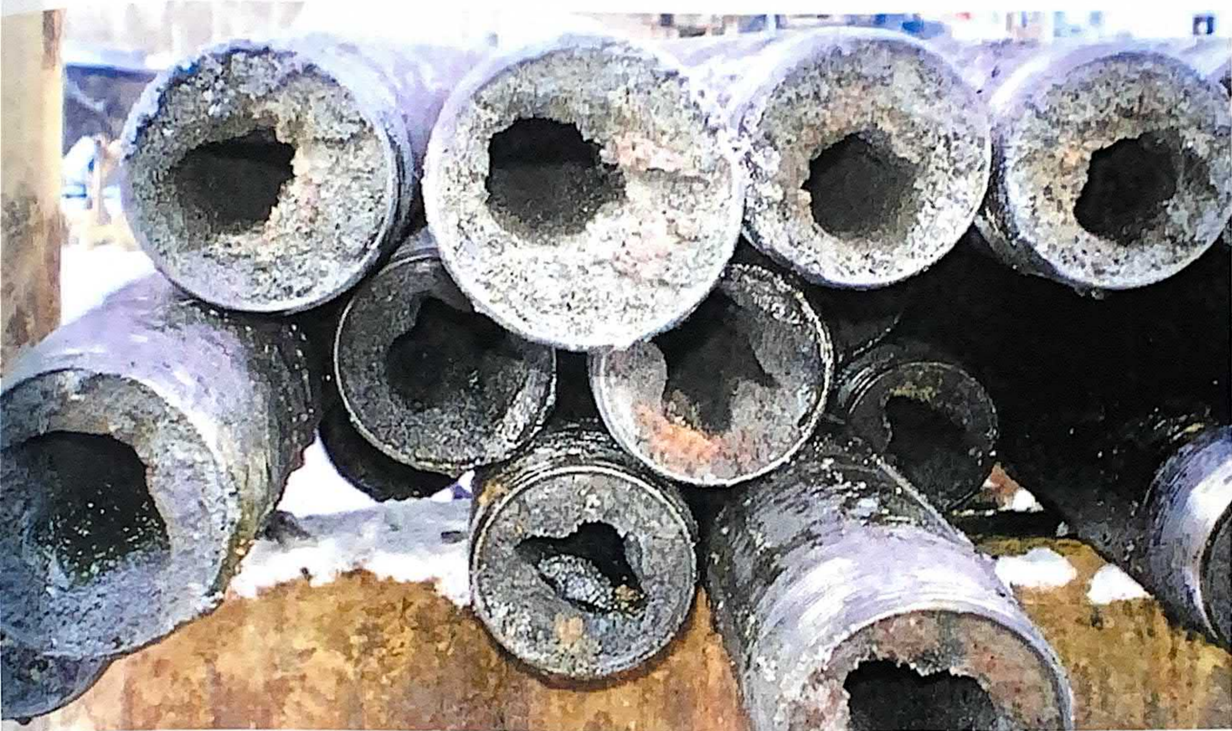
Рисунок 1.4 Асфальтопарафінові (АСПВ) відкладення в НКТ.
