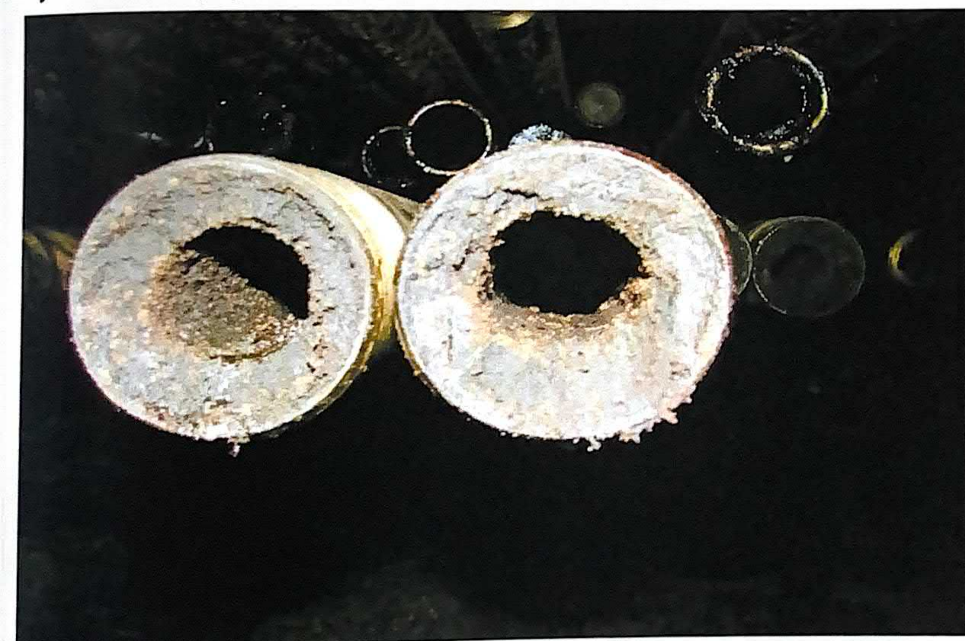
Рисунок 1.2 Парафінові відкладення в НКТ.
