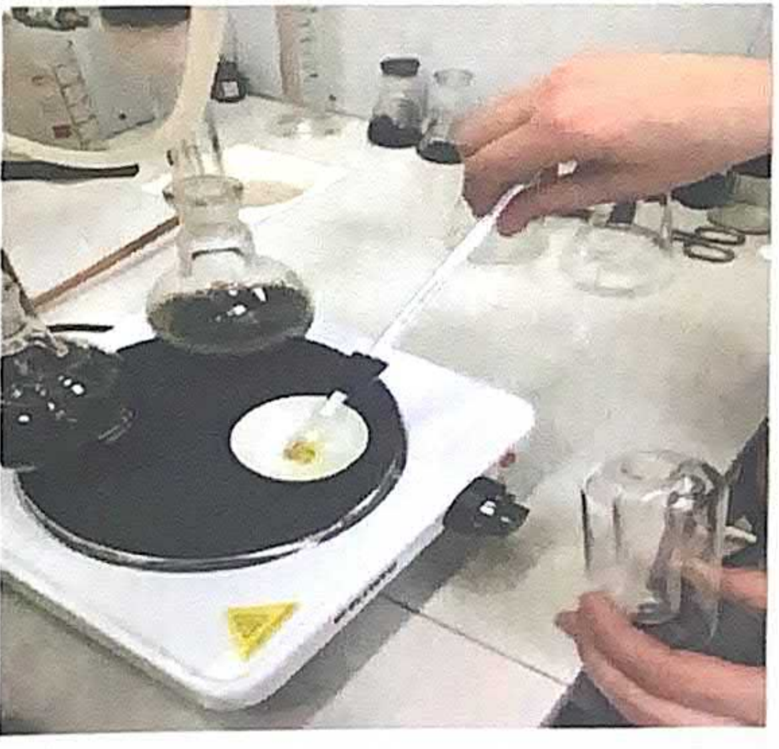
Рисунок 2.6 – Визначення парафінів в нафті. СОУ 11.1-00147631-069:2004 Стандарт організації. Порядок проведення лабораторних експериментів. Визначення компонентного складу нафти і конденсату.
