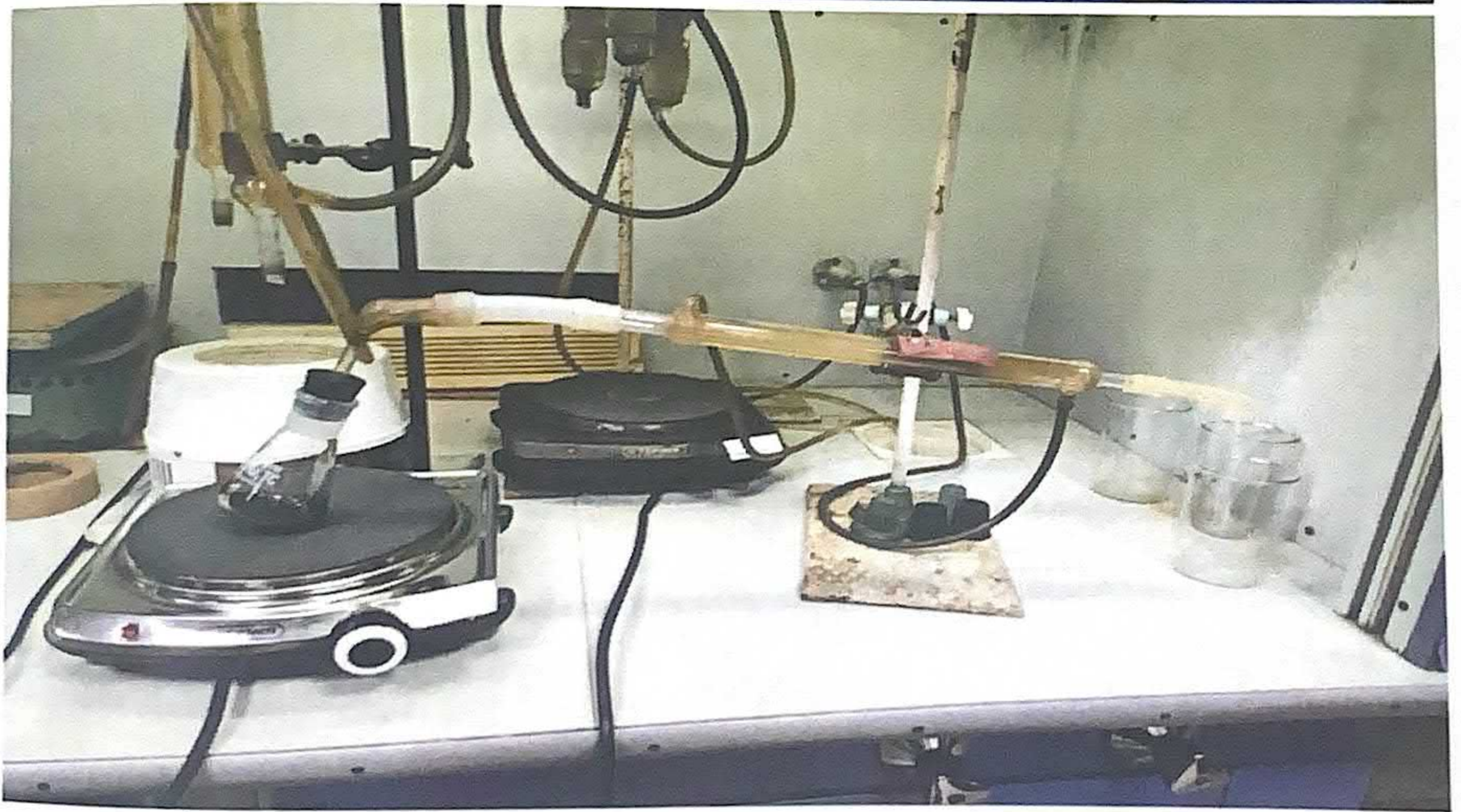
Рисунок 2.7 – Визначення смол в нафті. СОУ 11.1-00147631-069:2004.
