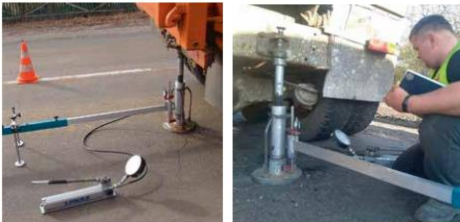
Рисунок 2.2.1 — Визначення модуля пружності асфальтобетонних шарів дорожнього одягу динамометричними установками ударної дії (зліва — універсальне дорожнє вимірювальне обладнання «УДВО», справа — установка динамічного навантаження «ДИНА-3М»)
