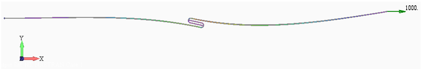
Рисунок 2.4.7 – Загальна схема деформацій з'єднання сталевих смуг
