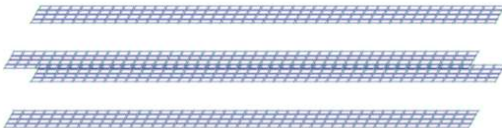
Рис. 4.3.10 – Згенеровані пластини полицок швелера балки
