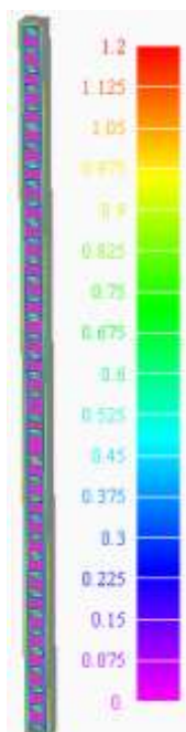
Напруження на поверхні бетонного ядра
