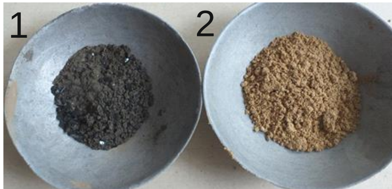
Рис. 1. Загальний вигляд компонентів суміші: 1 –зола виносу Миколаївської ТЕС; 2 – суглинок лесовий.
