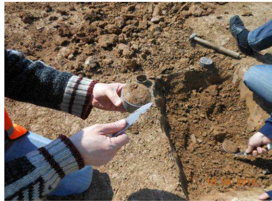
*Рис. 3. Відбір зразків ущільненого ґрунту методом ріжучих кілець*
