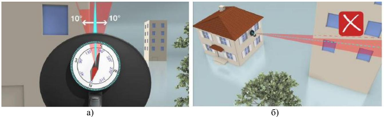
Рис. 6. Визначення напрямку на супутник
